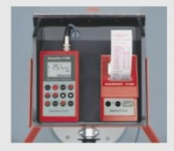
Das StratoTest-Gerät kann in zwei Arbeitsmodi verwendet werden, im DIREKT-Modus und im BAUSTELLEN-Modus. Der DIREKT-Modus ist für die sofortige Messung gedacht:
