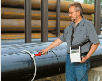
Porenprüfung an Pipelines
