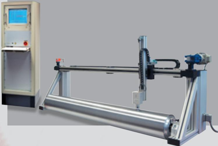
Dickenmessanlage zur Messung von unmagnetischen Flachbahnen
